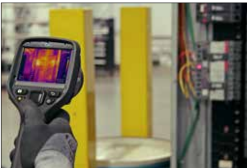
Laserpointer markieren das Zielobjekt für Tageslicht-Referenzbilder.
