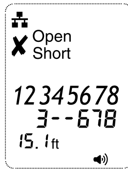
Unterbrechung und Kurzschluss
