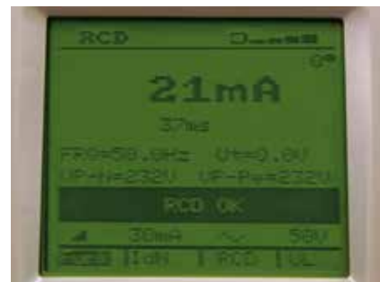
RCD Test mit ansteigendem Prüfstrom und Anzeige der Messergebnisse
