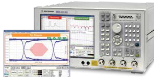
E5071C Netzwerkanalysator mit TDR-Option und Augendiagramm
