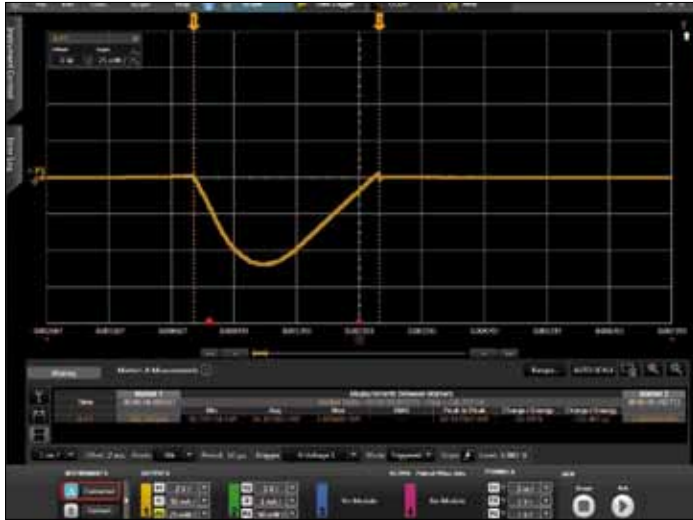
Bild 4. Der Energy Harvester wird an eine elektronische Last angeschlossen, um seine Leistung zu messen. Anhand von Markern auf der Leistungskurve lässt sich die abgegebene Energie messen – hier in \mu\text{J} .
