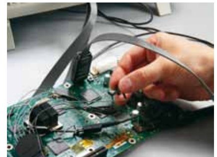
Der Digitalstastkopf P6316 für die MSO2000-Serie vereinfacht die Verbindung zum Prüfling
