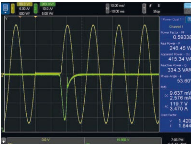
Bild 5. Mit einem Kanal des IntegraVision PA2201A lässt sich dieser primärseitige Dropout der AC-Versorgungsspannung für ein DC-Netzgerät (gelbe Kurve) aufnehmen und gleichzeitig der Spannungseinbruch von ca. 600 mV und die Einschwingzeit von ca. 10 ms auf der 20V-DC-Seite darstellen. (Bild: dataTec)
