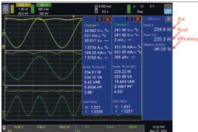
Bild 3. Screenshot vom IntegraVision PA2201A zur Messung des Konverters. Die tabel- larische Zusammenstellung der Messergebnisse gibt Auskunft über den Wirkungsgrad und die Wirkleistungen nebst den anderen Charakteristika. (Bild: datatec)
