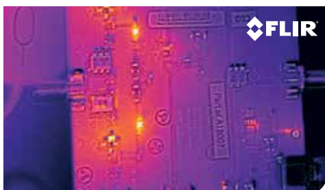
Wärme bild mit MSX. Mit MSX können Sie noch mehr Details auf dem Wärme bild erkennen.
